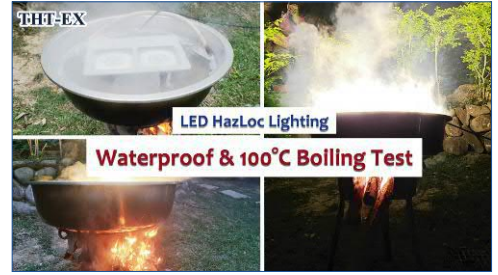
ランプの防水& 100°C沸騰水試験
